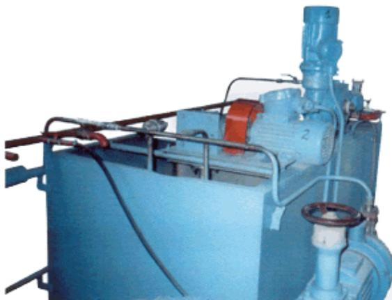
Блок предназначен для разделения отработанных буровых растворов на техническую воду и шлам. Используется в циркуляционных системах буровых установок всех классов, в особенности при безамбарном бурении. Работает в комплекте с центрифугой.
